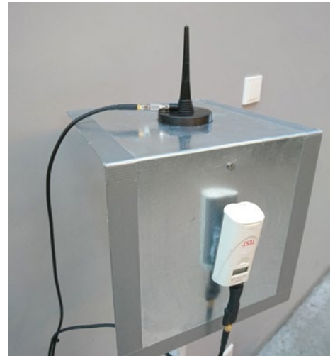
Abbildung 1: Messaufbau mit Scanner-Antenne (oben) und Gehäuse, in dem die Antenne für die Speisung des Quectel-BG96-Moduls untergebracht ist
